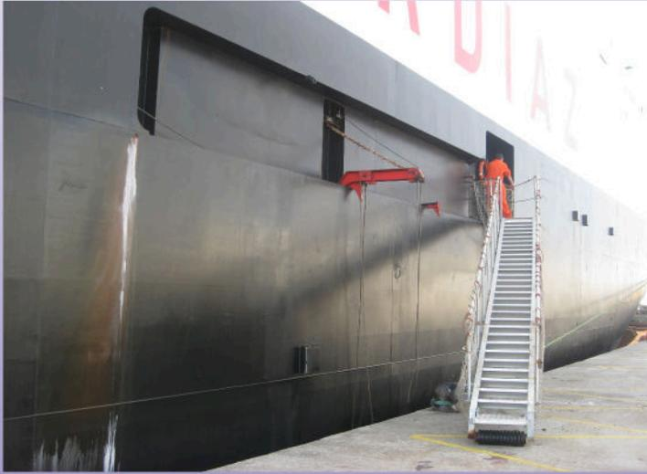
Escala real integramente fabricada en aluminio segun normas ISO 5488:1979.
